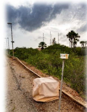
Figure 2 : Bac à eau sur son trépied métallique et SPM Honeywell sur le chemin de ronde AR5 Service OPTIQUE VIDEO CNES
