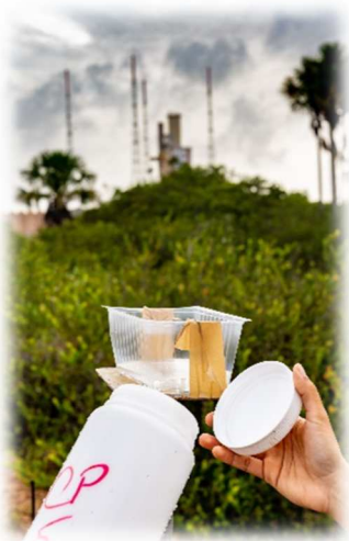
Figure 3 : Dépose d'un bac à eau avec son flacon d'échantillonnage
