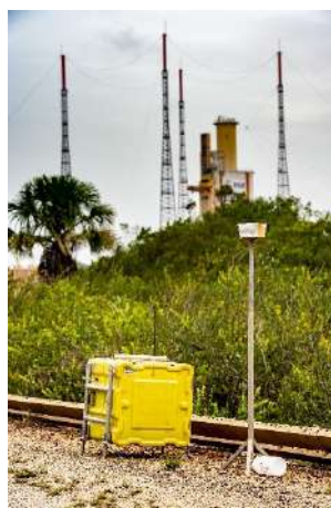
Figure 6 : SPM mobile installé en champ proche
