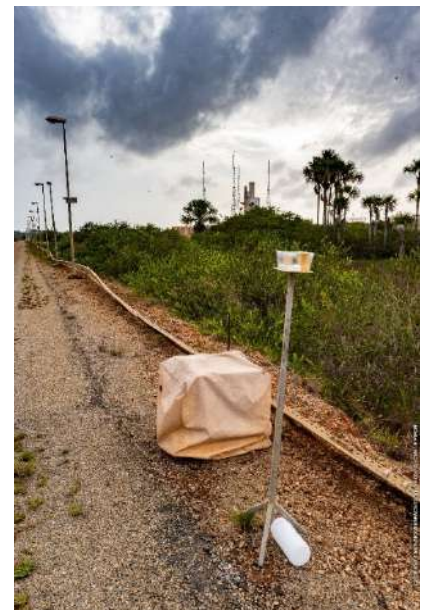
Figure 2 : Bac à eau sur son trépied métallique et SPM Honeywell sur le chemin de ronde AR5 Service OPTIQUE VIDEO CNES
