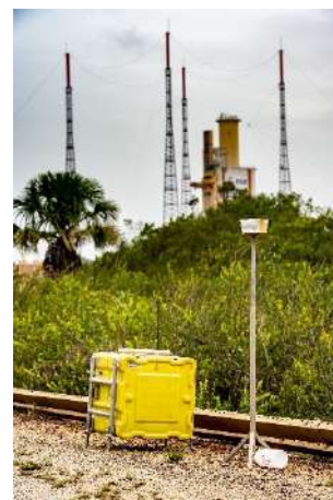
Figure 6 : SPM mobile installé en champ proche
